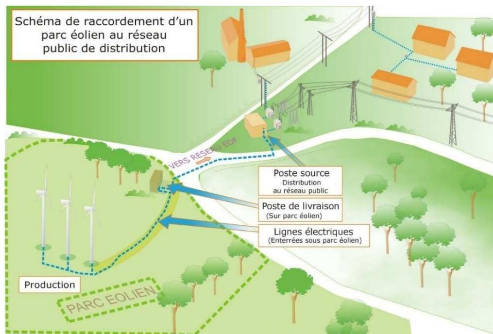
Figure 16 : Raccordement électrique au réseau de distribution (Source : ADEME)
